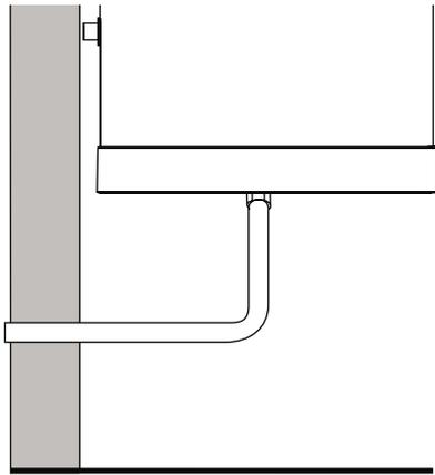
fig. 57 - Esempio di collegamento scarico condensa senza sifone
