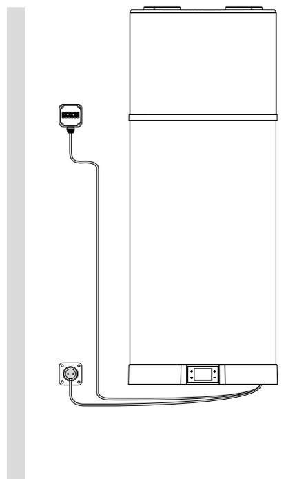
fig. 61- Esempio di collegamento a distanza
