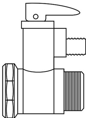
fig. 55 - Valvola di sicurezza 0.7 MPa (7 bar)
