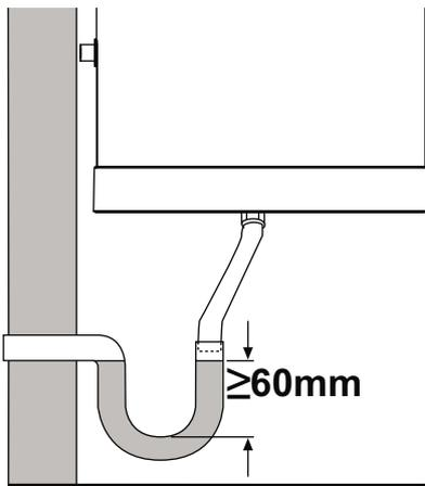
fig. 58 - Esempio di collegamento scarico condensa con sifone
