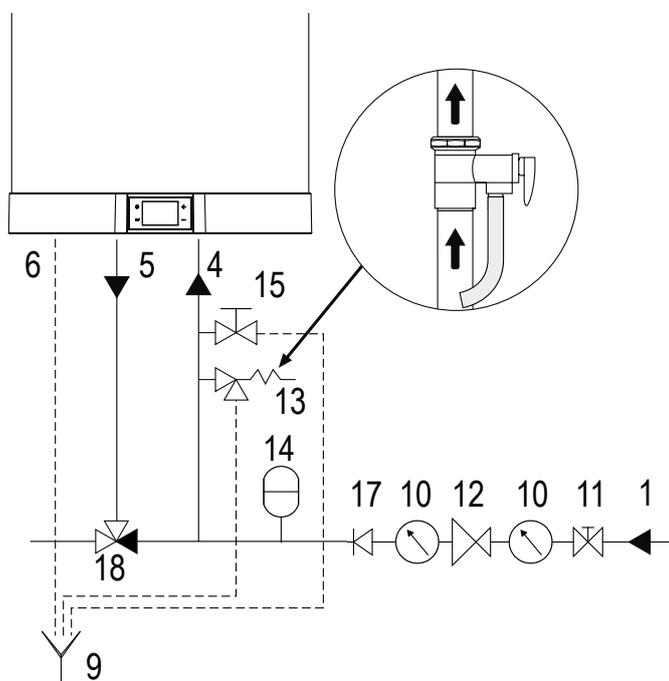
fig. 56 - Esempio impianto idrico
