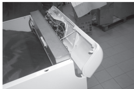
Fig. 6 - Rode o painel de comandos para a frente.
