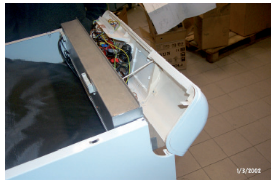
Fig. 6 - Girar hacia adelante el panel de mandos.
